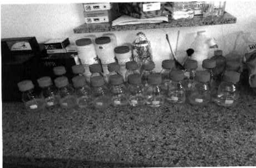
Foto 02 – Amostras de água em procedimento bacteriológico após 24 horas em Meio Colitag – os frasco contendo água amarela apresentam se POSITIVAS para Coliformes Totais e/ou E. coli
