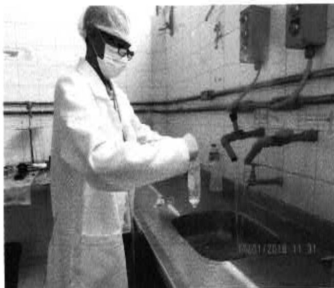
Fig. 37 – Coleta de água tratada no Laboratório de Operações das ETA's I e IV – Águas de Teresina
